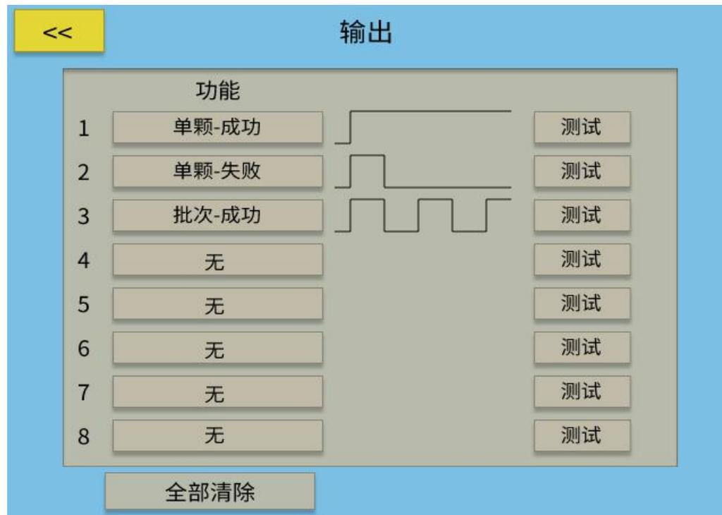
共有 8 个输出供用户进行编程。上图中的数字分别表示 8 个不同输出，点击相应的按钮进入具体设置界面（如下图），设置完成后结果会显示出来，并可按“测
