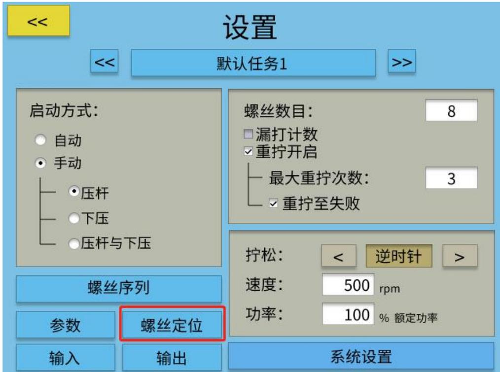
3、无输入密码进入“螺丝定位”的界面：
